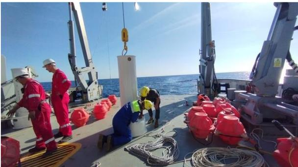
Preparazione di una trappola per sedimenti prima della rimessa a mare del mooring BB
