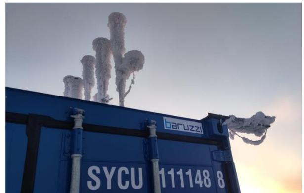
Le teste di prelievo per l'aerosol ricoperte di ghiaccio.
