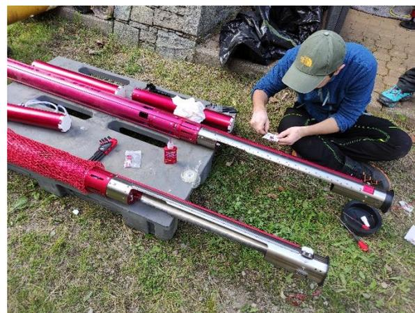
Assemblaggio del carotiere elettrotermico (crediti: Fabrizio De Blasi)
