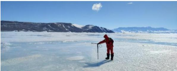
Figura 1: Misura le proprietà ottiche della superficie con uno spettrometro (Crediti: ©PNRA)
